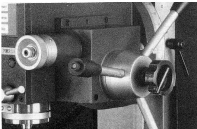
9. Фрезерный станок имеет большой диапазон применений: он может использоваться для углового фрезерования и горизонтального фрезерования (прежде чем двигать переднюю бабку, необходимо ослабить винт с головкой под торцевой ключ с правой стороны, затем ослабить две гайки, чтобы наклонить). Если вам необходимы дополнительные аксессуары для рабочей поверхности, см. рисунки ниже.
