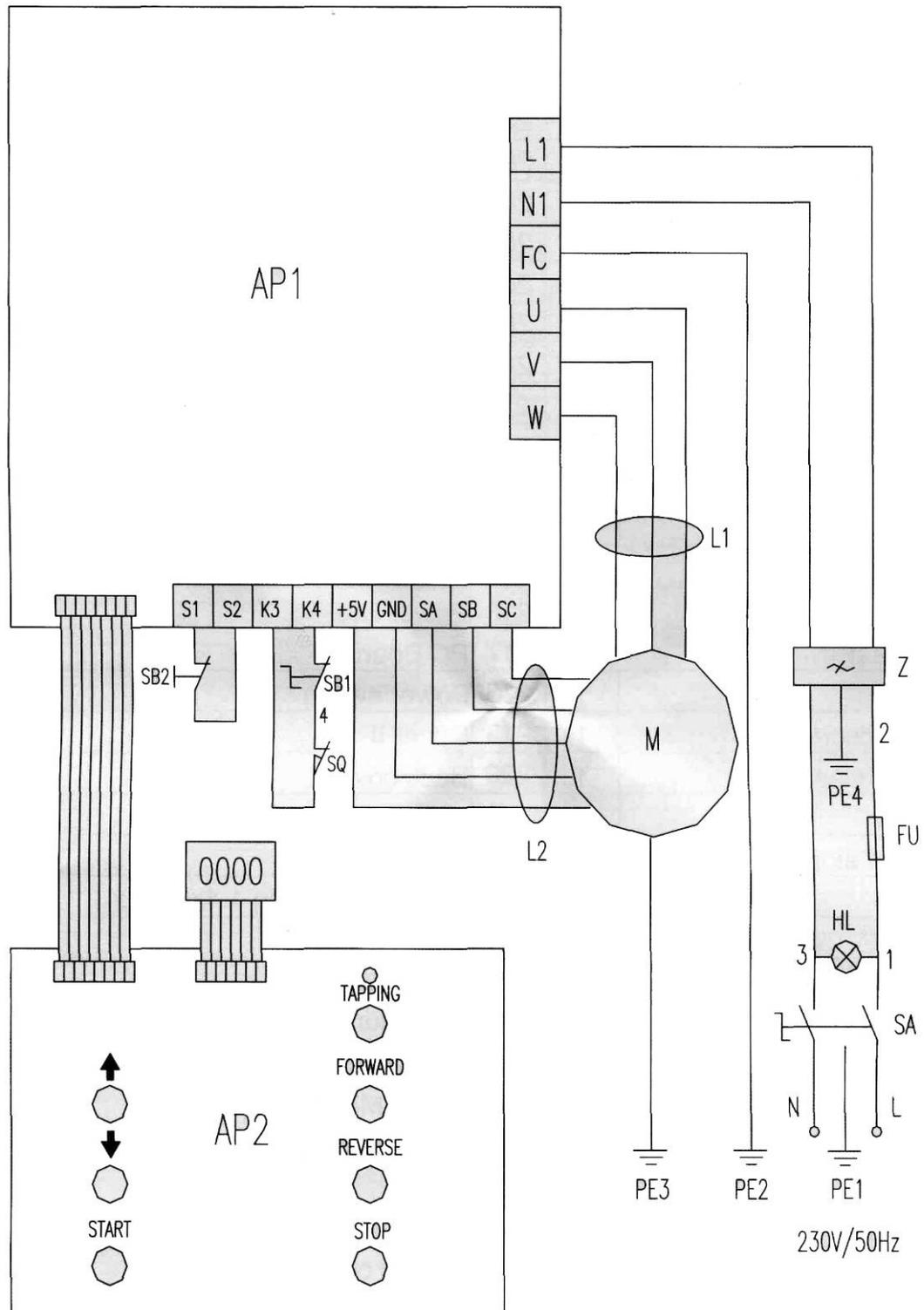
Электрическая схема (110V)
