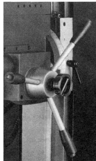
8. Функция тонкой подачи: Когда малый ручной фиксирующий маховик (А) заблокирован, контрольная рукоятка (В) не может быть использована. Поверните ручной маховичок тонкой подачи (С), чтобы шпиндель немного сменил положение.
