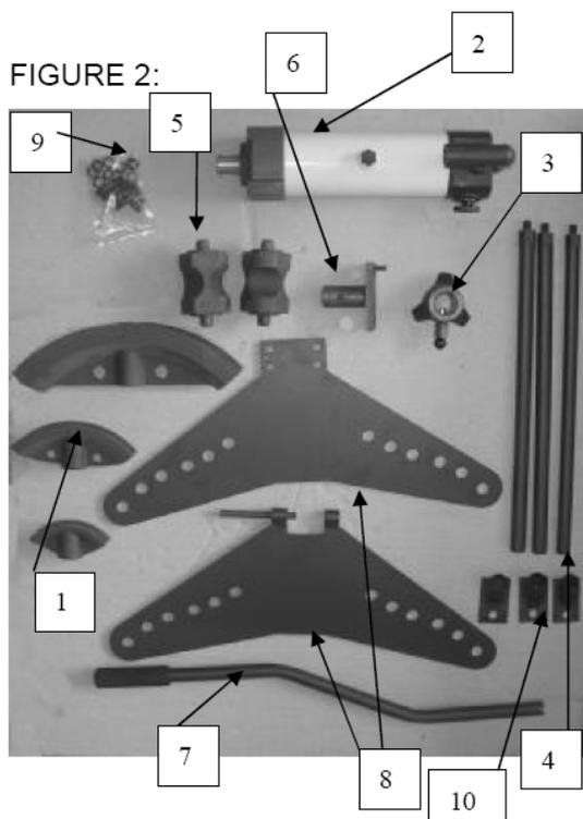
**Примечание:** трубогиб поставляется в разобранном виде в деревянном ящике или паллете, как показано на Рис. 2. Перед сборкой проверьте все детали, указанные на Рис. 2.
