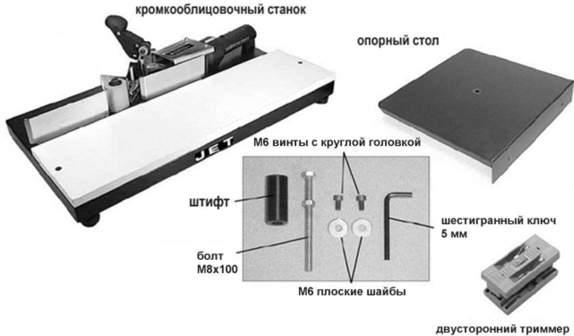
Станок имеет несскользящую резиновую опору, встроенный нож для глубокого разреза и широкий опорный стол для рулона кромкооблицовочного материала. Нагревательный элемент имеет бесконечное число регулировок с диапазоном нагрева от 100 до 200 градусов. Регулирующиеся направляющие помогают управлять с кромкооблицовочным материалов шириной до 57 мм.
