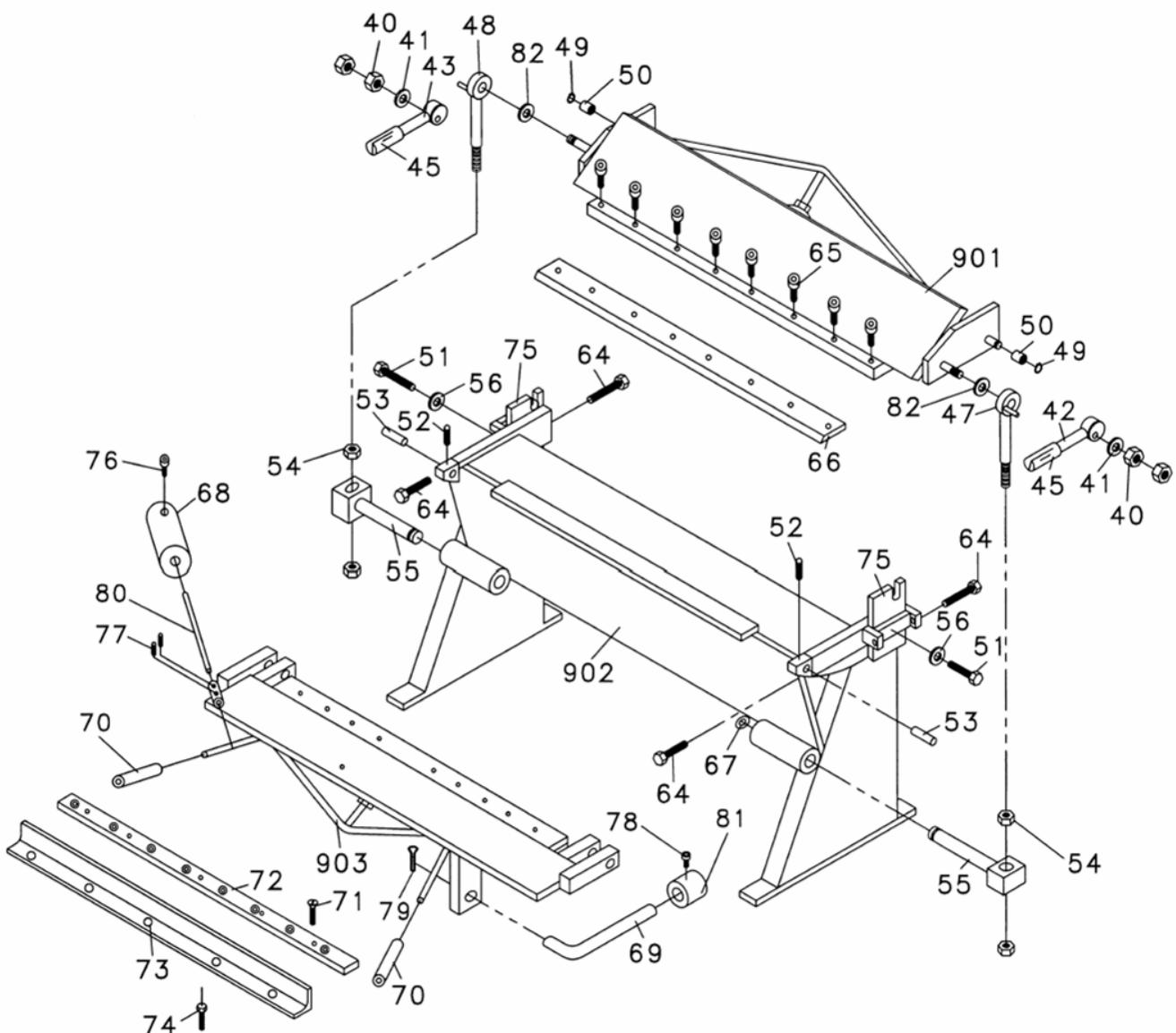
инструкция по эксплуатации станка JET мод.HB-1650N
