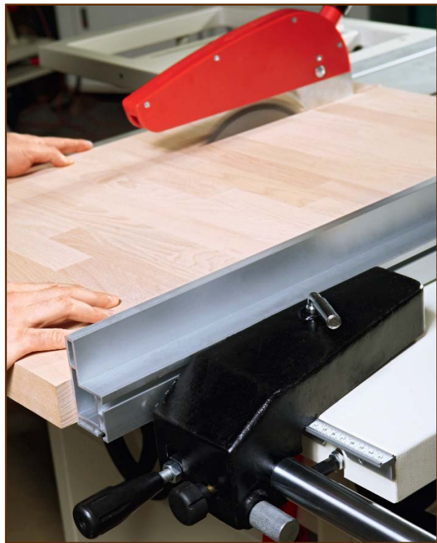
Модель JTS-600XL Параллельный упор перемещается по собственной направляющей и фиксируется при помощи специального рычага
