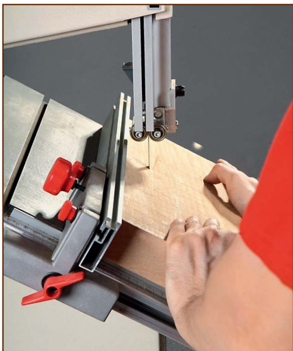
Модели JWBS-9X и JBS-12 Рабочий стол наклоняется на угол до 45 градусов
